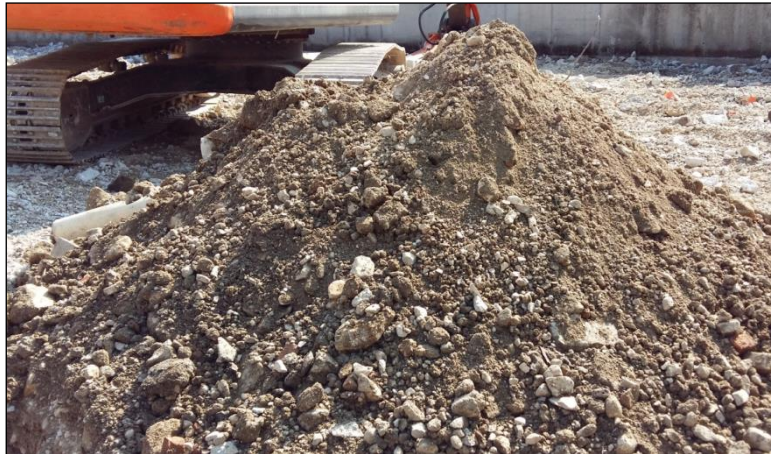
Alluvioni grossolane di fondovalle osservate in uno scavo svolto nella zona produttiva di Seghe di Velo
